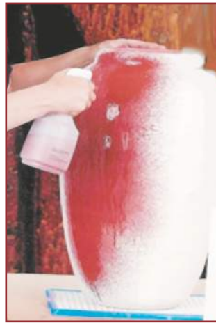
الشكل (٣١): استخدام البخاخة في تطبيق البطانات.
