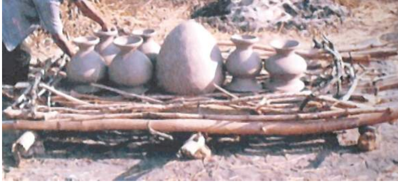
الشكل ( ٣٦ ) : الطريقة التقليدية لتجفيف البطانات .
