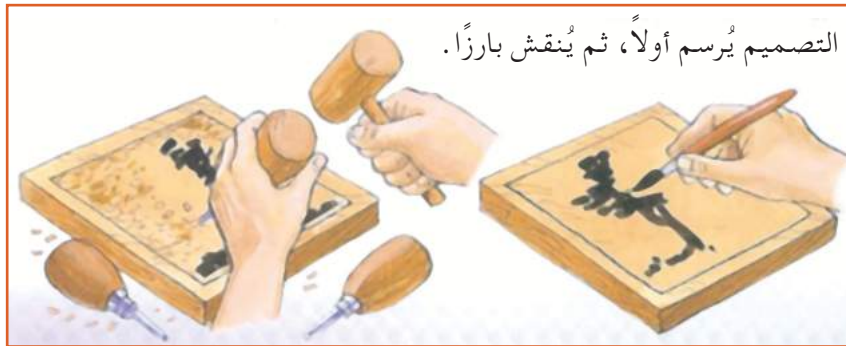
الشكل (١١٤): طريقة تنفيذ الإشارات بالحفر على الخشب.
